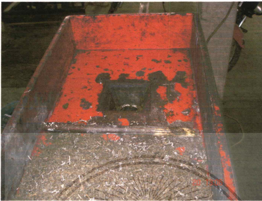
ภาพที่ ค 5 บริเวณใส่วัสดุคิบมีขนาดเล็กไม่เหมาะกับการผลิตระบบอุตสาหกรรม
