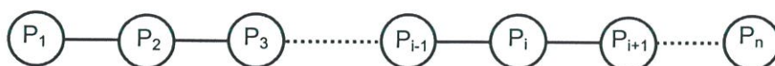
รูปที่ 2.13 โครงสร้างการติดต่อแบบอะเรย์เชิงเส้น
