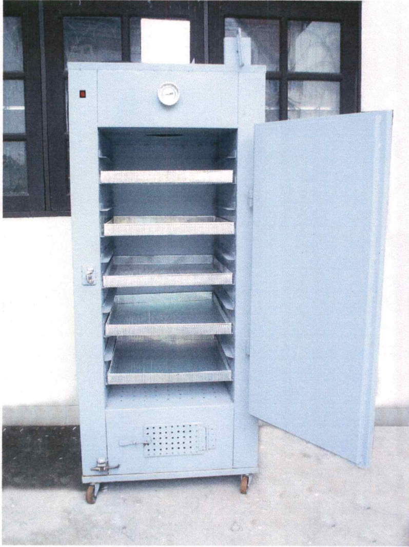
ภาพที่ ค12 แสดงต้นแบบเครื่องอบแห้งผลิตภัณฑ์กระชูด
