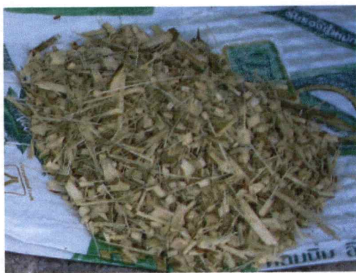
ภาพที่ ค14 ภาพแสดงผลของทางมะพร้าวที่ทำการทดสอบประสิทธิภาพด้านการบดย่อยแล้ว
