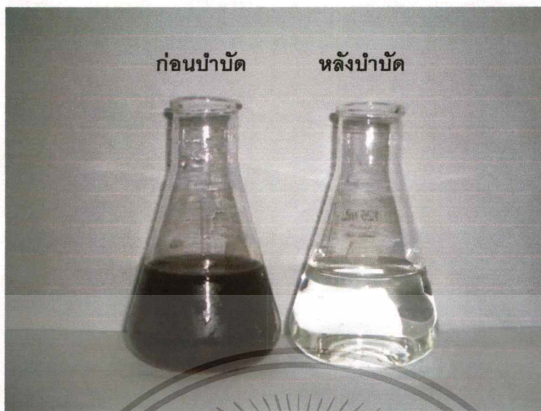
รูปที่ จ.1.11 รูปแสดงก่อนและหลังการบำบัดสีย้อมจากกระบวนการฟอกย้อมสิ่งทอพื้นบ้านโดยใช้ เศษผงเหล็ก (วันที่ 11)
