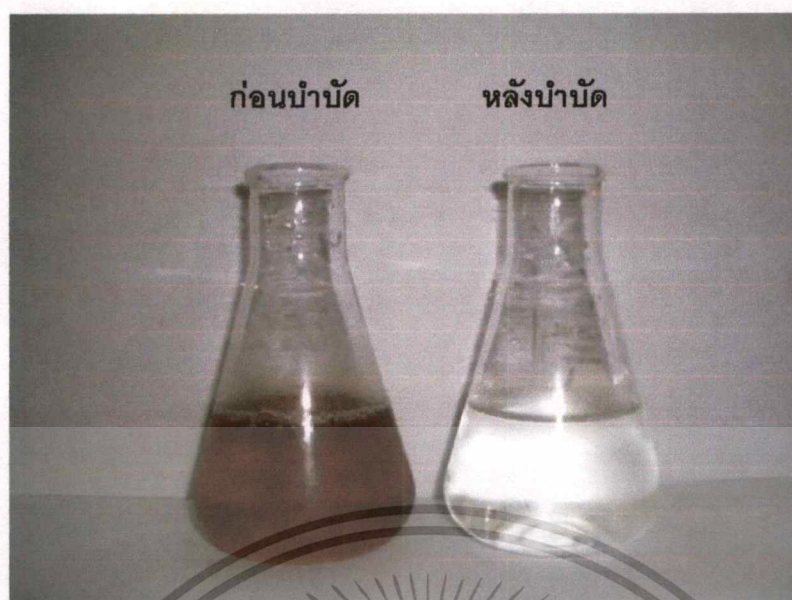
รูปที่ ๑.1.3 รูปแสดงก่อนและหลังการบำบัดสีย้อมจากกระบวนการฟอกย้อมสิ่งทอพื้นบ้านโดยใช้ เศษผงเหล็ก (วันที่ 3)
