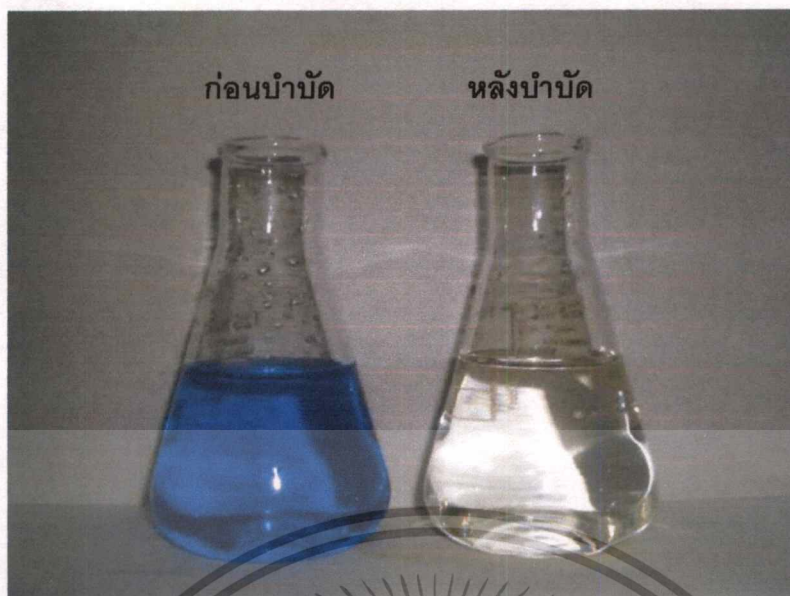
รูปที่ ๑.1.9 รูปแสดงก่อนและหลังการบำบัดสีย้อมจากกระบวนการฟอกย้อมสิ่งทอพื้นบ้านโดยใช้ เศษผงเหล็ก (วันที่ 9)
