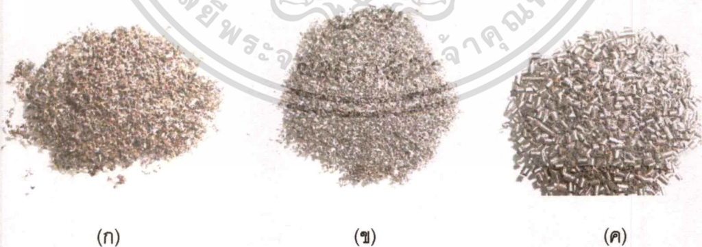
รูปที่ 4.1 ลักษณะทางกายภาพของเศษผงเหล็กแต่ละชนิด (ก) เศษผงเหล็กเหนียว (ข) เศษผงเหล็กกล้า (ค) เศษผงเหล็กหล่อ
