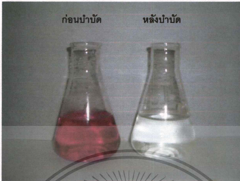
รูปที่ ๑.1.1 รูปแสดงก่อนและหลังการบำบัดสีย้อมจากกระบวนการฟอกย้อมสิ่งทอพื้นบ้านโดยใช้ เศษผงเหล็ก (วันที่ 1)
