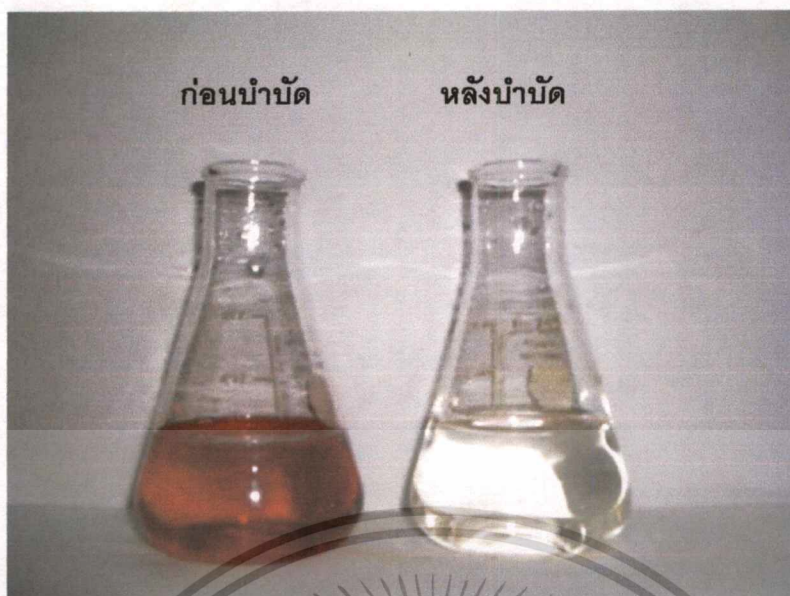
รูปที่ จ.1.15 รูปแสดงก่อนและหลังการบำบัดสีย้อมจากกระบวนการฟอกย้อมสิ่งทอพื้นบ้านโดยใช้ เศษผงเหล็ก (วันที่ 15)
