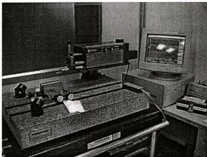
ภาพที่ จ.9 เครื่อง Surfanalyzer รุ่น 5000 ของ Fedral USA. วัดความลึกร่องผิวงาน
