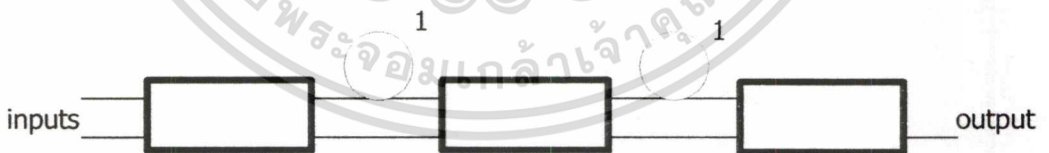
รูปที่ 2.18 บัฟเฟอร์ทางแสงที่ใช้สถาปัตยกรรมการสวิตช์ switch delay line (SDL)
