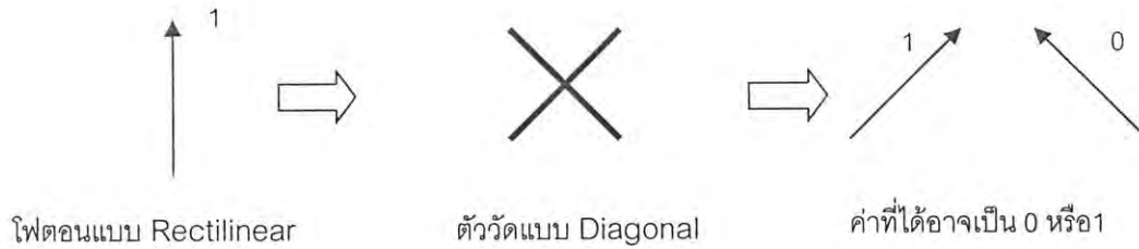
รูปที่ 3.5 การวัดค่าโฟตอนโดยใช้ตัววัดที่ไม่ถูกต้อง ค่าที่ได้จะเป็นค่าสุ่มโดยมีโอกาสถูกและผิดเท่ากัน
