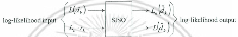
รูปที่ 2.6 ตัวถอดรหัสแบบซอฟต์แวร์อินพุต/ซอฟต์แวร์เอาต์พุต
