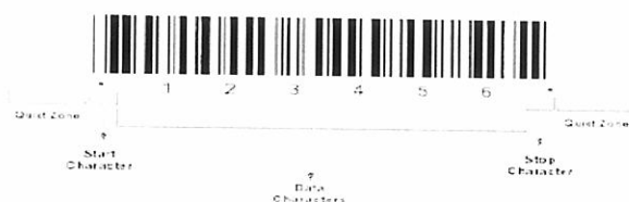
ภาพที่ 7 โครงสร้างการทำงานของระบบ Barcode
