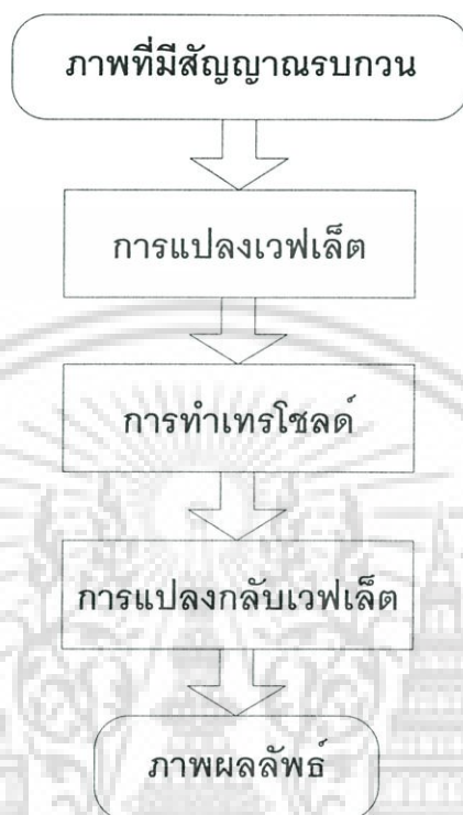
รูปที่ 4.1 บล็อกไดอะแกรมแสดงการกำจัดสัญญาณรบกวนด้วยการทำเทรซอลด์กับสัมประสิทธิ์เวฟเล็ต
