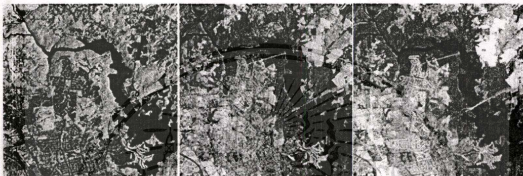
(ก) ภาพถ่ายดาวเทียมแบนด์ที่ 4 (ข) ภาพถ่ายดาวเทียมแบนด์ที่ 5 (ค) ภาพถ่ายดาวเทียมแบนด์ที่ 6 รูปที่ 5 ภาพที่ได้จากการปรับเท่าฮิสโตแกรมในพื้นที่ทั้งหมด
