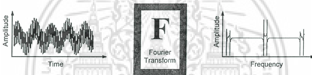
รูปที่ 2.11 การวิเคราะห์สัญญาณในทางเวลาไปเป็นสัญญาณในทางความถี่ ด้วยการแปลงฟูริเยร์
