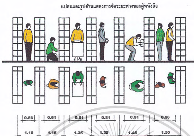
ภาพที่ 2.43 รูปด้านระยะห่างของชั้นวางหนังสือ
