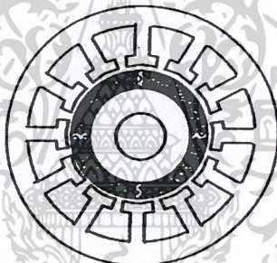
รูปที่ 2.11 สเตเตอร์ของ Brushless DC มอเตอร์
