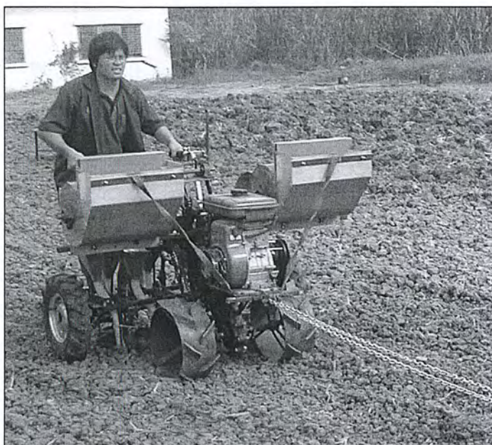
ภาพที่ 4.11 แสดงทดสอบการใช้งานเครื่องปลูกในแปลงภาควิชา
