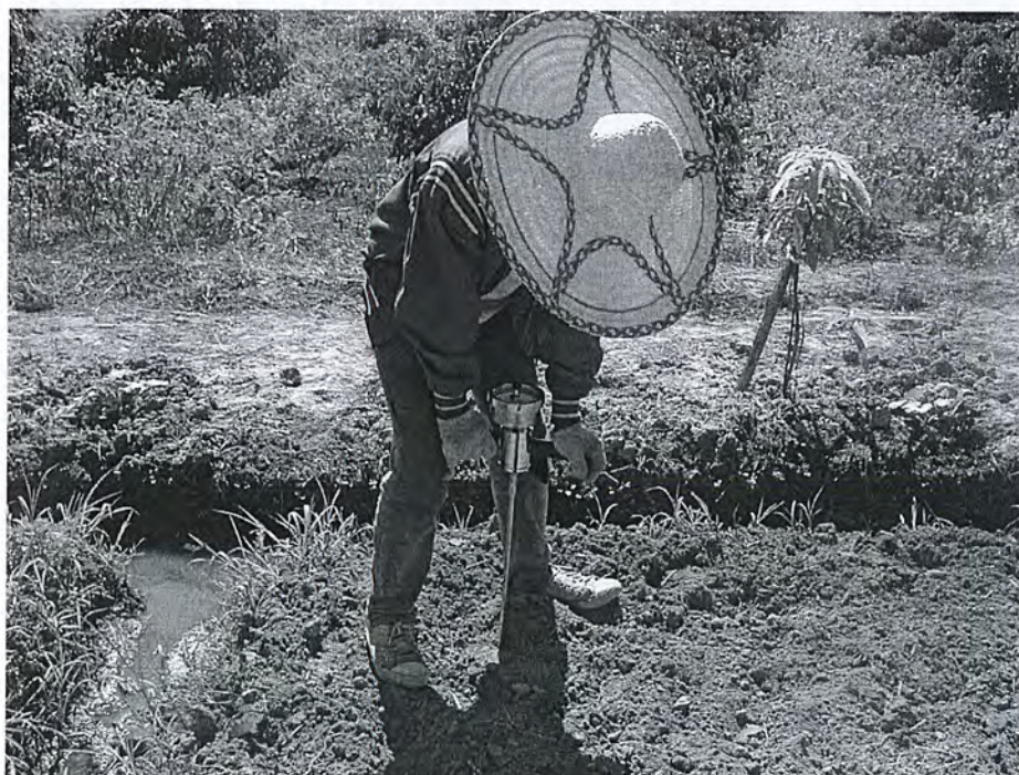
ภาพที่ 4.16 แสดงการหาค่าความแข็งดิน(cone index)
