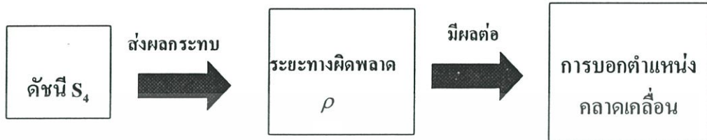
รูปที่ 4.4 ปัจจัยที่ส่งผลกระทบต่อระยะทางเทียม ซึ่งมีผลต่อความแม่นยำในการบอกพิกัดของเครื่องรับ GPS
