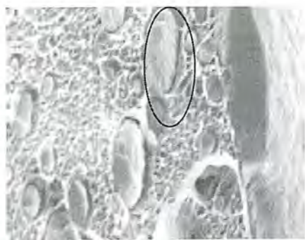
รูปที่ 4.12 SEM กำลังขยาย 1,000 เท่า แสดงการกระจายตัวของเม็ดสีฟลูออเรสเซนซ์ 50 phr ในพอลิเอทิลีนชนิดความหนาแน่นสูงที่นำกลับมาใช้ใหม่ที่ไม่มีการเติมกรดสเตียริก
