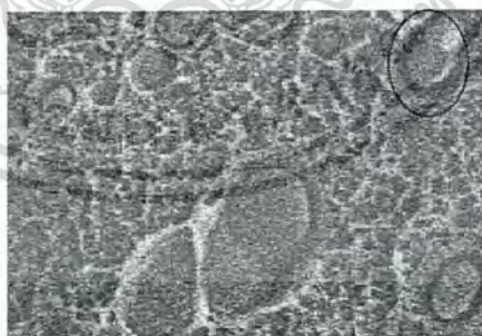
รูปที่ 4.14 SEM กำลังขยาย 1,000 เท่า แสดงการกระจายตัวของเม็ดสีฟลูออเรสเซนซ์ 50 phr ในพอลิเอทิลีนชนิดความหนาแน่นสูงที่นำกลับมาใช้ใหม่ที่มีการเติมกรดสเตียริก 3 phr
