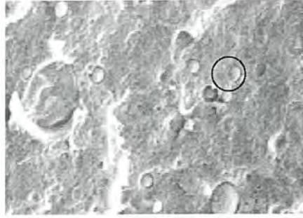
รูปที่ 4.6 SEM กำลังขยาย 1,000 เท่า แสดงการกระจายตัวของเม็ดสีฟลูออเรสเซนซ์ 10 phr ในพอลิเอทิลีนชนิดความหนาแน่นสูงที่นำกลับมาใช้ใหม่ที่ไม่มีการเติมกรดสเตียริก
