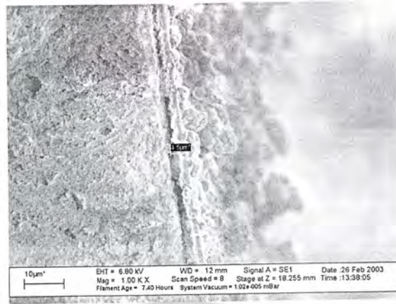
รูป ค-7 ภาพถ่ายภาคตัดขวางของแคลเซียมซิลิเกต (G-25) ที่ผ่านการแช่สารละลาย SBF เป็นเวลา 25 วัน ที่กำลังขยาย 1,000 เท่า
