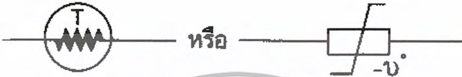
ภาพที่ 2.34 สัญลักษณ์ตัวต้านทานชนิดเปลี่ยนค่าได้ตามอุณหภูมิ
