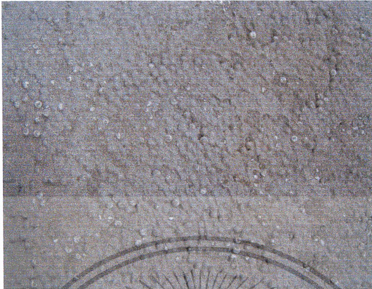
รูปที่ ผ.ก.1. แสดงลักษณะการลอยตัวของส่วนผสมที่เป็นโฟมบนผิวแผ่นผนังโฟมกรีต
