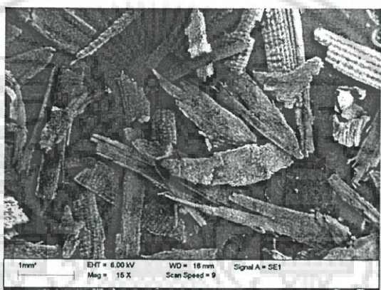
รูปที่ 4.2 ภาพถ่ายจากกล้องจุลทรรศน์อิเล็กตรอนแบบส่องกราดกำลังขยาย 15 เท่าของแกลบที่มีขนาด 35-50 ไมครอน
