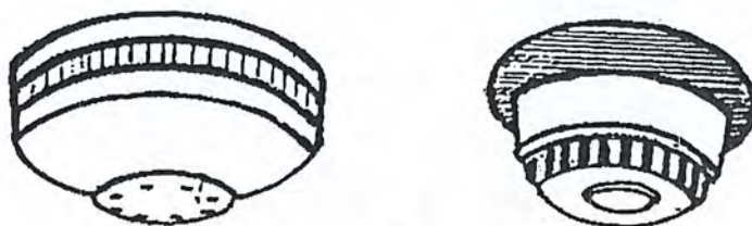
ภาพที่ 2.72 ชนิดของเครื่องตรวจจับเพลิง
