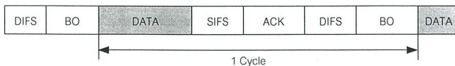
รูปที่ 4.6 แผนผังเวลาการส่งข้อมูล IEEE 802.11
