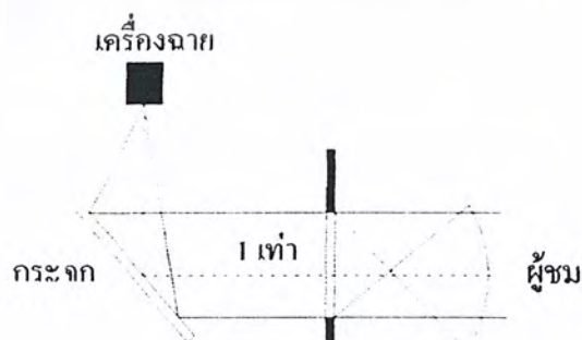
ภาพที่ 2.2.2 - 14 การใช้มุมหักเหในการตั้งเครื่องฉาย
