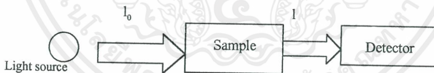
รูปที่ 2.6 การวัดแบบ Transmittance
