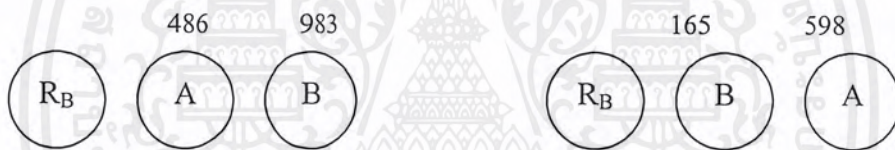
รูป 3.6 ข วิธีการทดสอบตัวอย่างคู่กับตัวอย่างมาตรฐาน แบบมาตรฐานสมดุล โดยใช้ตัวอย่าง B เป็นตัวอย่างมาตรฐาน
