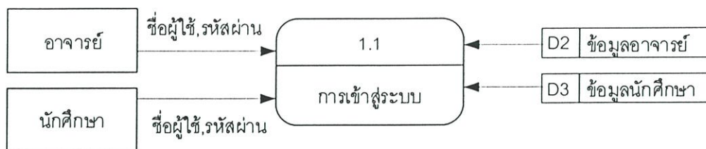
ภาพที่ 3.3 Data flow diagram level 2 การเข้าสู่ระบบ
