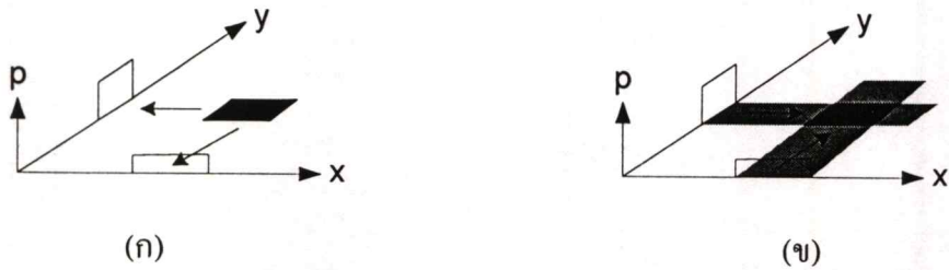
รูปที่ 2.2 ตัวอย่างของการสร้างภาพตัดขวางตามวิธีการแบ็กโปรเจกชัน
