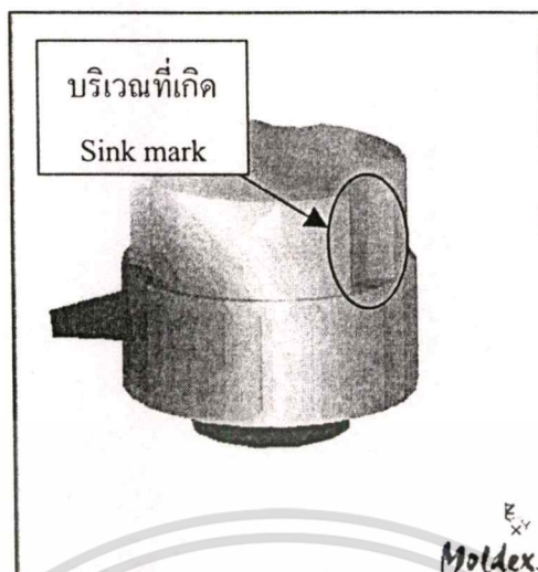
รูปที่ 5.133 แสดงตำแหน่งที่เกิด Sink mark
