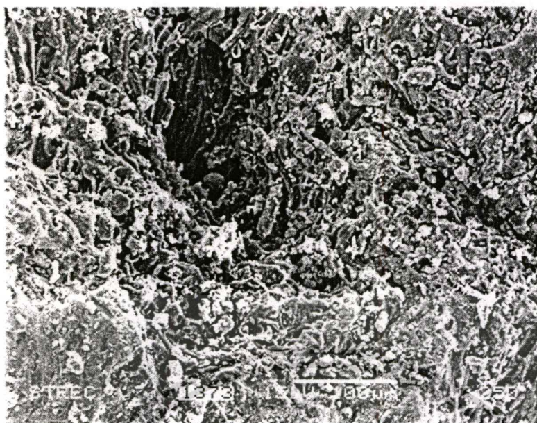
รูปที่ 5.8 รูป SEM ของคาร์บอนกัมมันต์เมื่อกระตุ้นด้วยสารละลายโซเดียมคลอไรด์อิ่มตัวที่กำลังขยาย 250 เท่า
