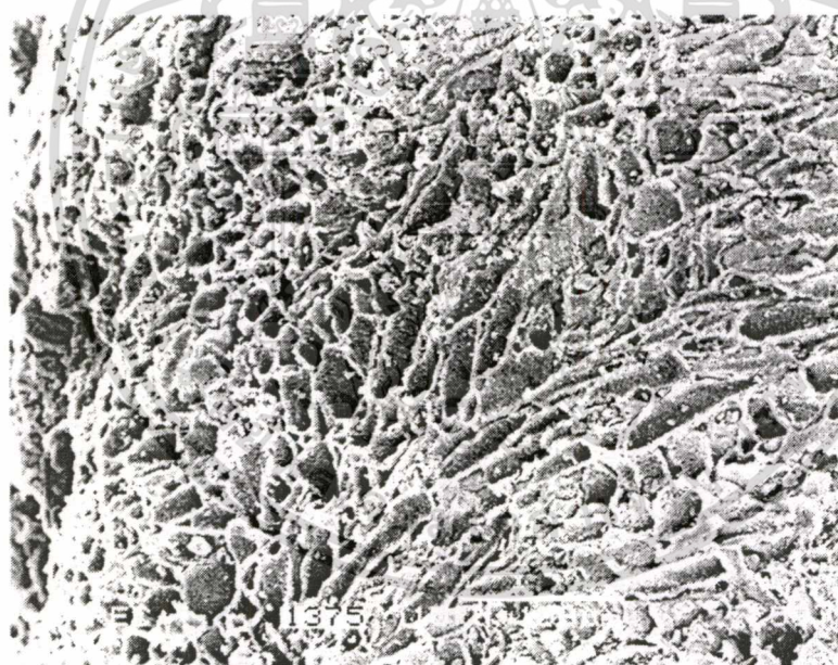
รูปที่ 5.7 รูป SEM ของคาร์บอนกัมมันต์เมื่อกระตุ้นด้วยสารละลายซิงค์คลอไรด์ 60% โดยน้ำหนัก ที่กำลังขยาย 250 เท่า
