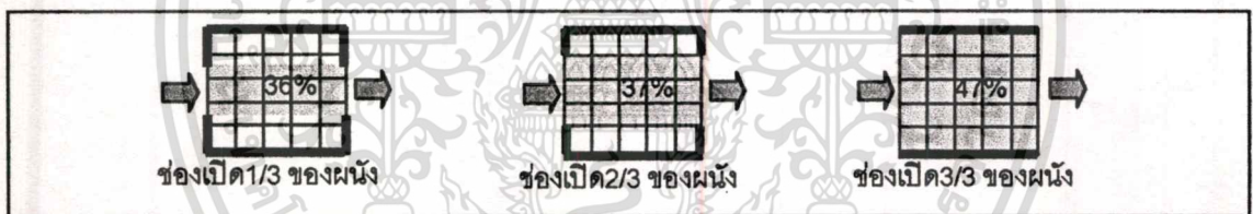
ภาพที่ 2.5 แสดงขนาดช่องเปิดที่ต่างกัน กรณีลมตั้งฉากเข้าสู่ช่องเปิด
