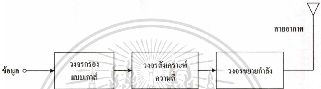
รูปที่ 8.1 บล็อกไดอะแกรมของวงจรเครื่องส่งของเครื่องรับส่งวิทยุระบบบลูทูธ
