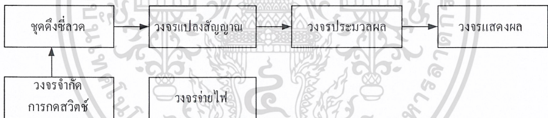
รูปที่ 3.1 แผนผังการทำงานของเครื่องวัดค่าความต้านแรงดึงขาดของซีลวดล้อรถจักรยานยนต์
