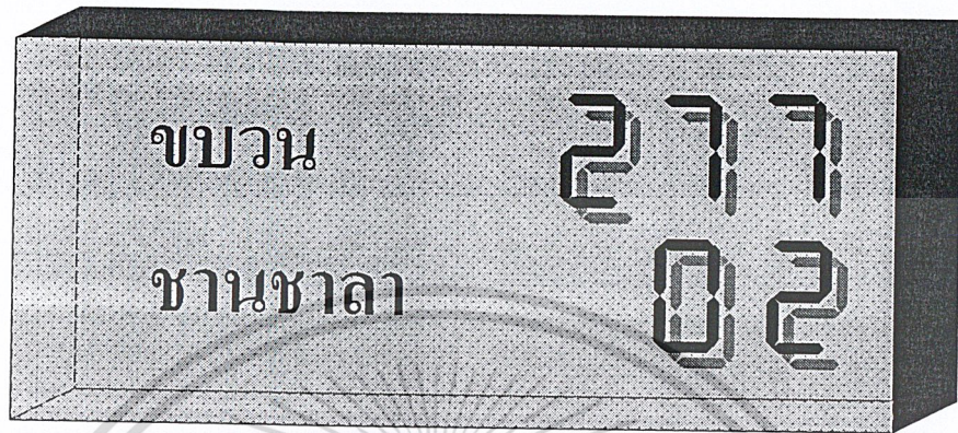
รูปที่ 4.5 ลักษณะจอแสดงผลเมื่อป้อนหมายเลขชานชาลาแล้ว
