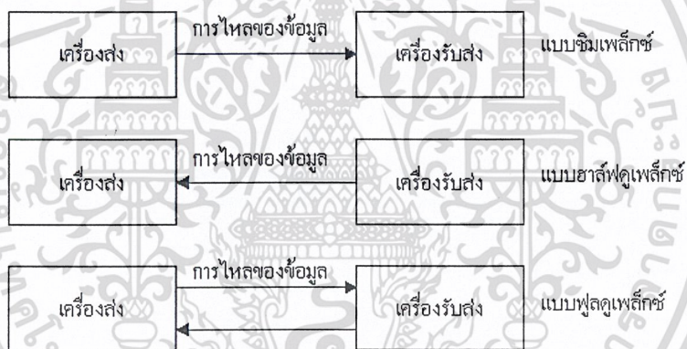
รูปที่ 2.5 รูปแบบของการติดต่อสื่อสารข้อมูลแบบอนุกรม
