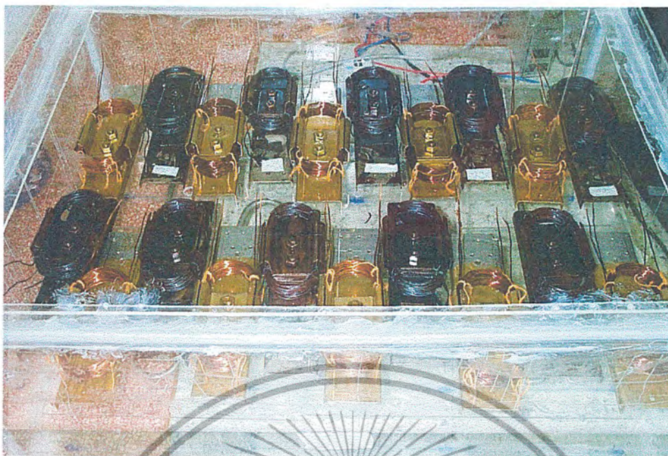
รูปที่ 5-7 การปรับสภาพทางความชื้นต่อแบบจำลองร่องสล็อตด้วยตู้อบไอน้ำ
