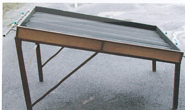
รูปที่ 3.7 โครงสร้างส่วนรับน้ำหนักของแผงรับรังสีแสงอาทิตย์
