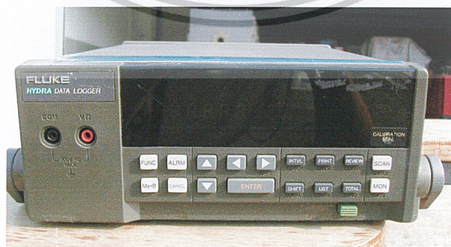
รูปที่ 3.12 เครื่องบันทึกและอ่านค่าอุณหภูมิดิจิทัล
