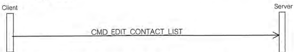
รูปที่ 3.8 ลำดับการส่งคำสั่งสำหรับการจัดกลุ่มใน contact list
