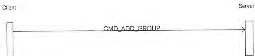
รูปที่ 3.9 ลำดับการส่งคำสั่งสำหรับการเพิ่มกลุ่มใน contact list
