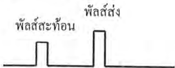
รูปที่ 4.5 แสดงคาบเวลาพัลส์สะท้อนกลับที่มากกว่าคาบเวลาพัลส์ส่ง
