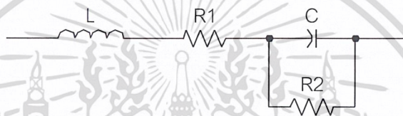
รูปที่ 2.13 อินดักแตนซ์ L เกิดจากโลหะตัวนำที่ขาของตัวเก็บประจุ R2
