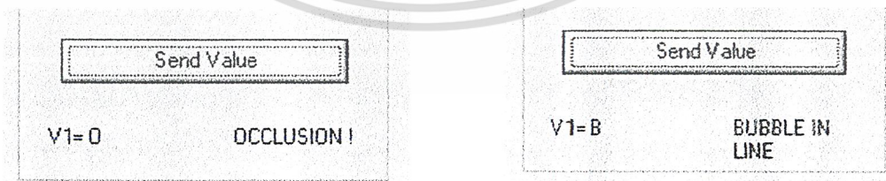
รูป 6.8 การแสดงผลการเกิดการอุดตันและฟองอากาศในสาย
