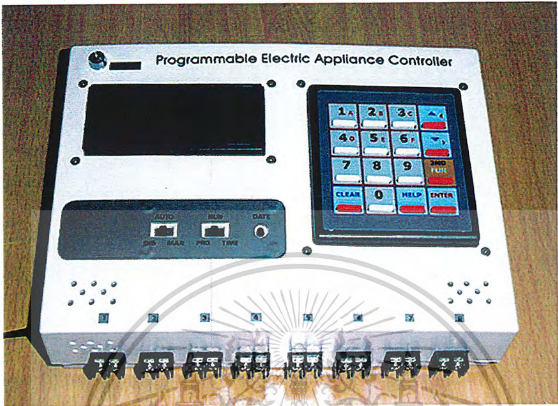
ด้านบน สวิตช์ควบคุม , Keypad , จอแสดงผล และ ด้านหน้า จุดต่อ โหลด
