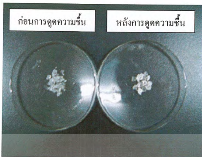
รูปที่ 4.12 ลักษณะของ \text{SiO}_2 ที่สังเคราะห์ ก่อนและหลังดูดซับความชื้น
