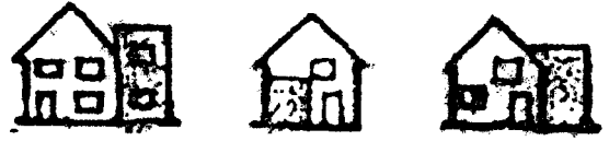
ภาพที่ 2.48 เส้นรอบนอก (Out line) และหน้าต่างของส่วนที่ต่อเติม ไม่เข้ากับของเดิม
