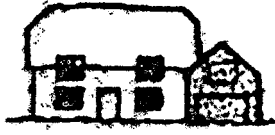
ภาพที่ 2.47 รูปร่างของหลังคาและขนาด ไม่เข้ากับตัวบ้านของเดิม
