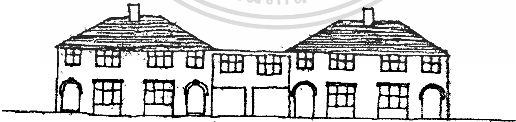
ภาพที่ 2.40 การต่อเติมที่ไม่เหมาะสม
