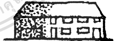
ภาพที่ 2.45 การต่อเติมโดยไม่คำนึงถึงรูปร่างเดิม ภาพที่ 2.46 การต่อเติมที่เข้ากันได้กับ ทำลายรูปแบบเดิมของบ้าน อาคารเดิม
