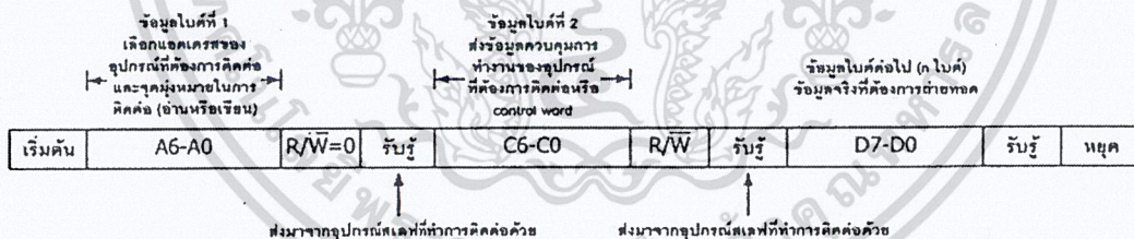
ภาพที่ 3.7 รูปแบบของข้อมูลอนุกรมที่ใช้ติดต่อกับอุปกรณ์บัส I 2 C เมื่อใช้การอ้างถึงแบบ 7 บิต
