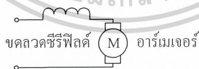
รูปที่ 2.4 โครงสร้างของมอเตอร์ไฟฟ้ากระแสตรงแบบอนุกรม
