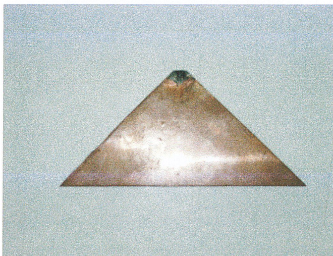
รูปที่ 3.9 รูปของตัวพีคของสายอากาศสี่เหลี่ยมคางหมู
