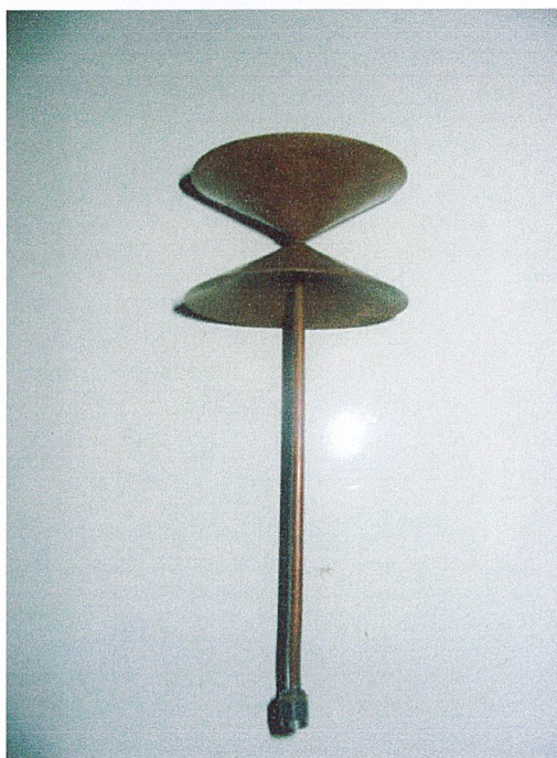
รูปที่ 3.6 สายอากาศไบโคนิคอลที่นำชิ้นส่วนต่างๆ มาประกอบกันในขั้นตอนสุดท้าย
