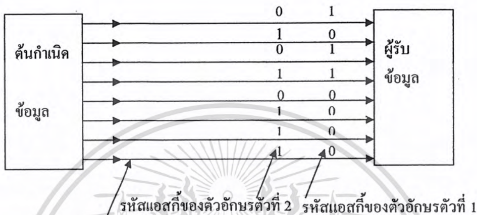
สายส่งสัญญาณทั้ง 8 เส้น ทุกบิตของแต่ละตัวอักษรจะวิ่งขนานกันไป และแต่ละตัวอักษรจะวิ่งเรียงลำดับกันไป รูปที่ 2.17 การส่งผ่านข้อมูลแบบขนาน
