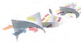
รูปที่ 2.13 ลักษณะการไหลแบบการแบ่งส่วนการไหล [12]
